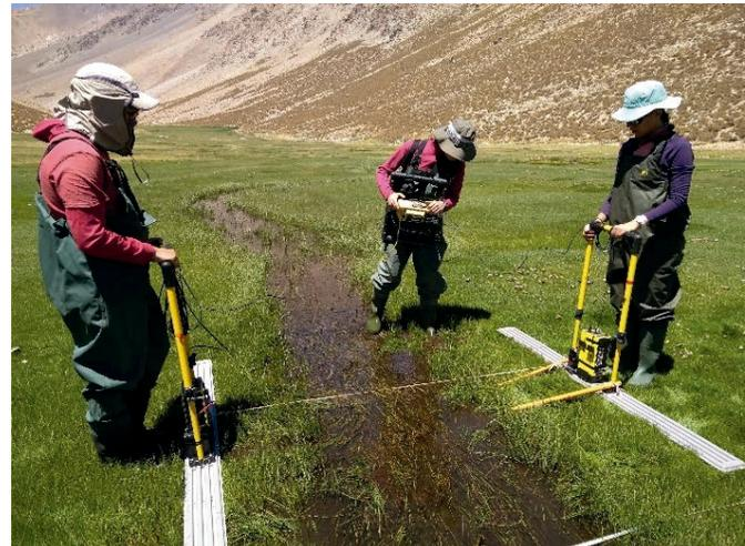
Técnicas de georadar para estudiar los depósitos del subsuelo y sus interfaces en capas de arena, turba, grava y limos.
